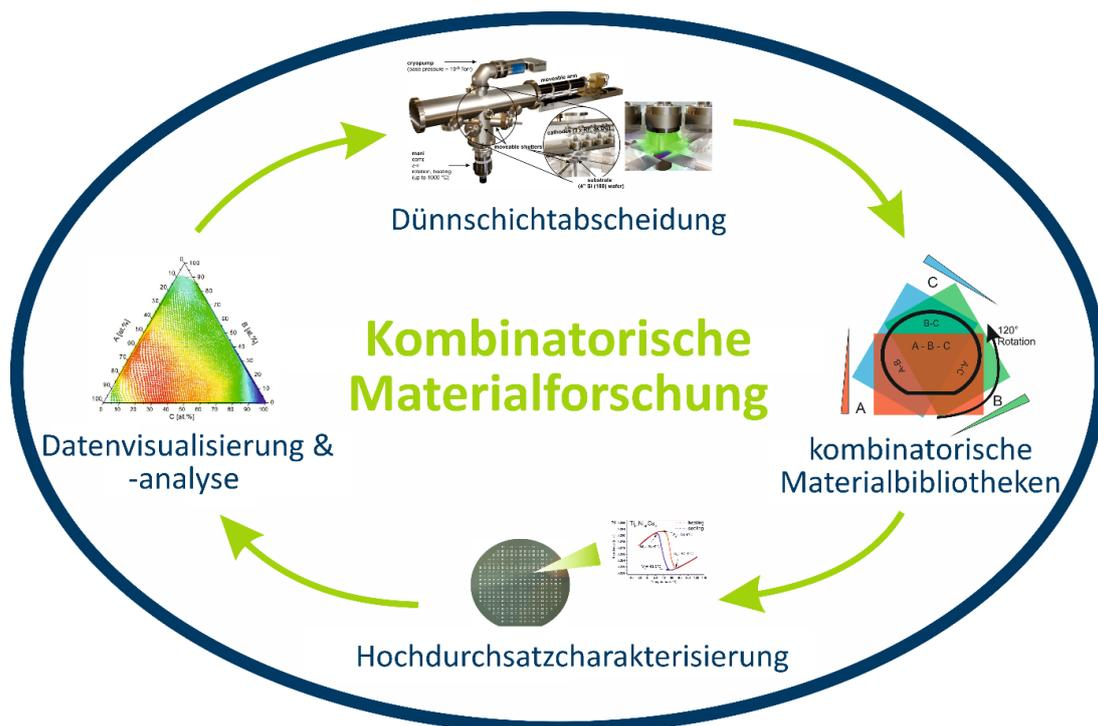
**Abb. 1.1:** Schematische Darstellung der Prozessschritte in der kombinatorischen Materialforschung [1].
