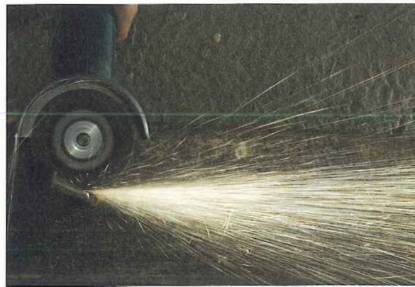
Abb. 4: Tangential wegfliegende Funken beim Flexen
