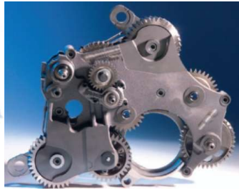
Trägerplatte und montierte Räderkassette für einen 10-Zylinder-Dieselmotor von VW
