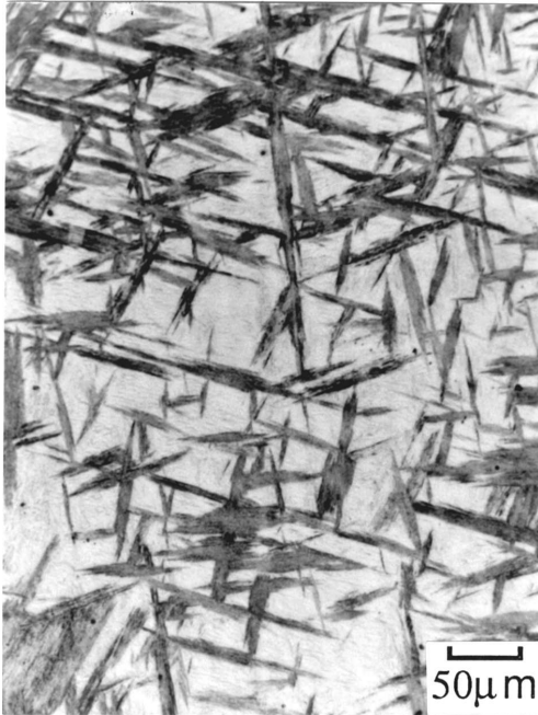
Lichtmikroskop dunkel: Bainit „sheaves“; hell: Martensit
