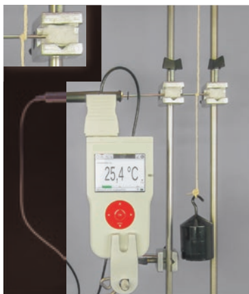
■ Abb. 6.6 Umwandlung von Höhenenergie in innere Energie (Skizze nach Bader 2001, S. 45; Versuchsaufbau nach Wiesner und Waltner (2009); die Schnur, an der das 1-kg-Massestück hängt, ist um einen Temperaturfühler gewickelt (s. Ausschnittvergrößerung))
