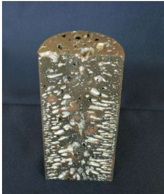
Abb.: Porenbildung durch Entweichen von Stickstoff aus einer Eisenschmelze
