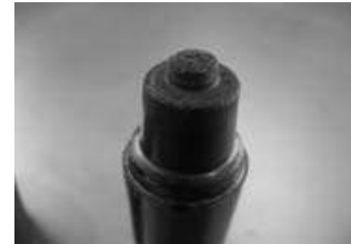
Verschleiß an Stempel nach 8 Schmiedungen
