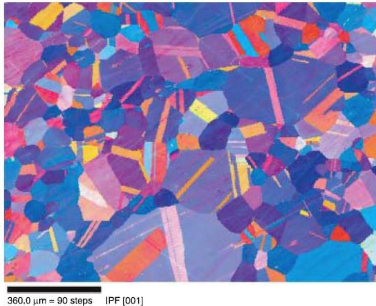
**Abbildung 15.** Beispiel eines EBSD Scans einer polykristallinen Ni-Superlegierung nach Dingley [1]. Inverse Pole Figure Map. Die  $[111]$  Orientierung ist in blau, die  $[001]$  in rot und die  $[101]$  in grün dargestellt.
