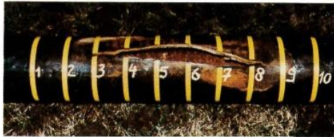
Bild 9. Der Verlauf des bei der Wasserdruckprüfung aufgetretenen Risses.
