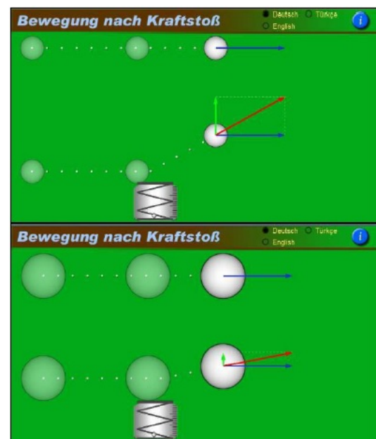
5.6 Unterschiedliche Massen bewirken unterschiedliche Zusatzgeschwindigkeiten (grüne Pfeile).
