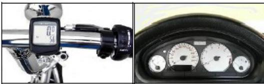
3.2 Tacho eines Fahrrads und eines Autos
