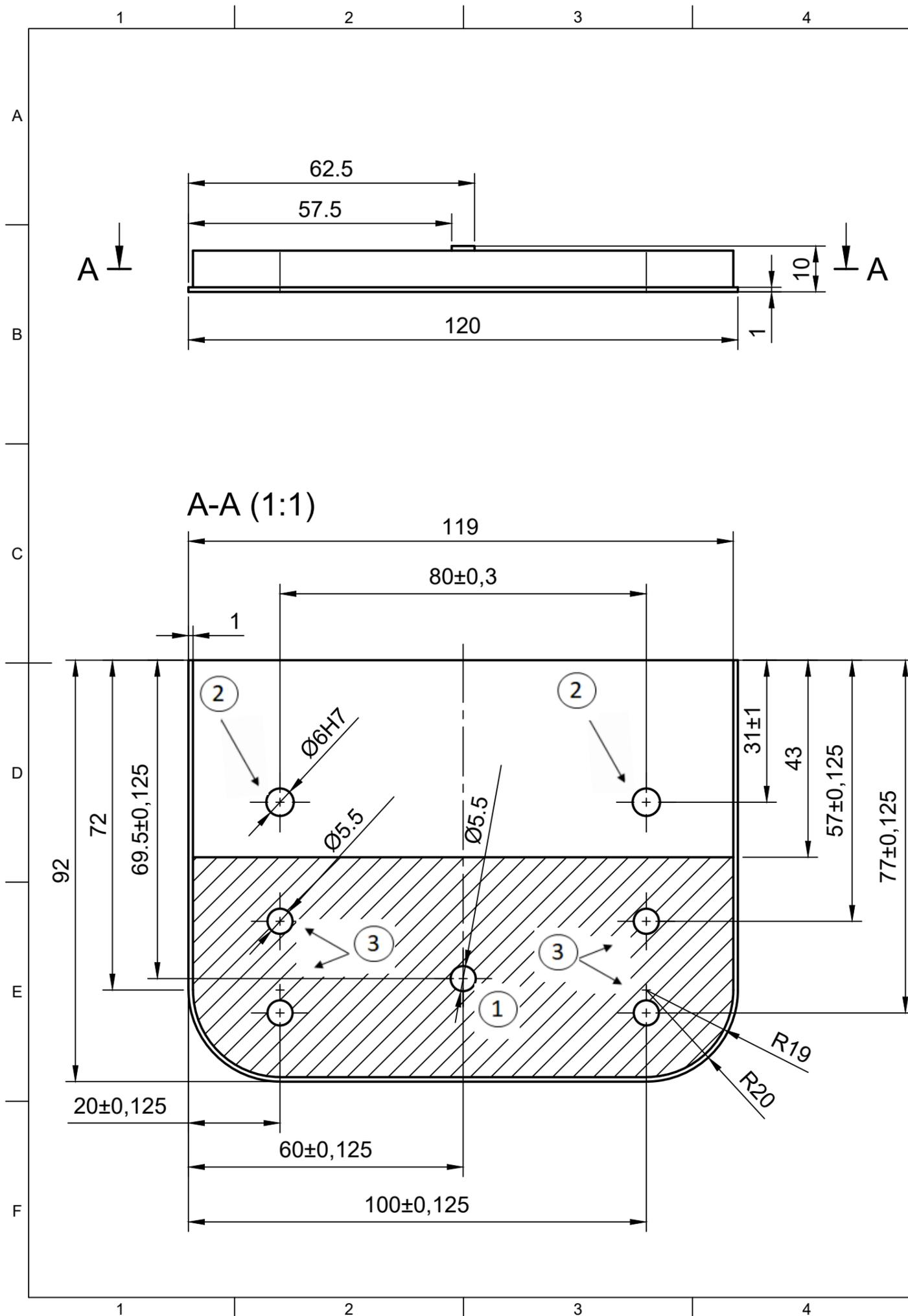
① Tolerierung von Bohrungspositionen an der "Bodenplatte" für die Schraubverbindung der Bodenplatte mit Durchgangsloch "mittel" Ø5,5mm mit dem Auffangbehälter mit Gewindebohrung M5. Ergänzen Sie die Toleranzangaben der Bohrungspositionen.
