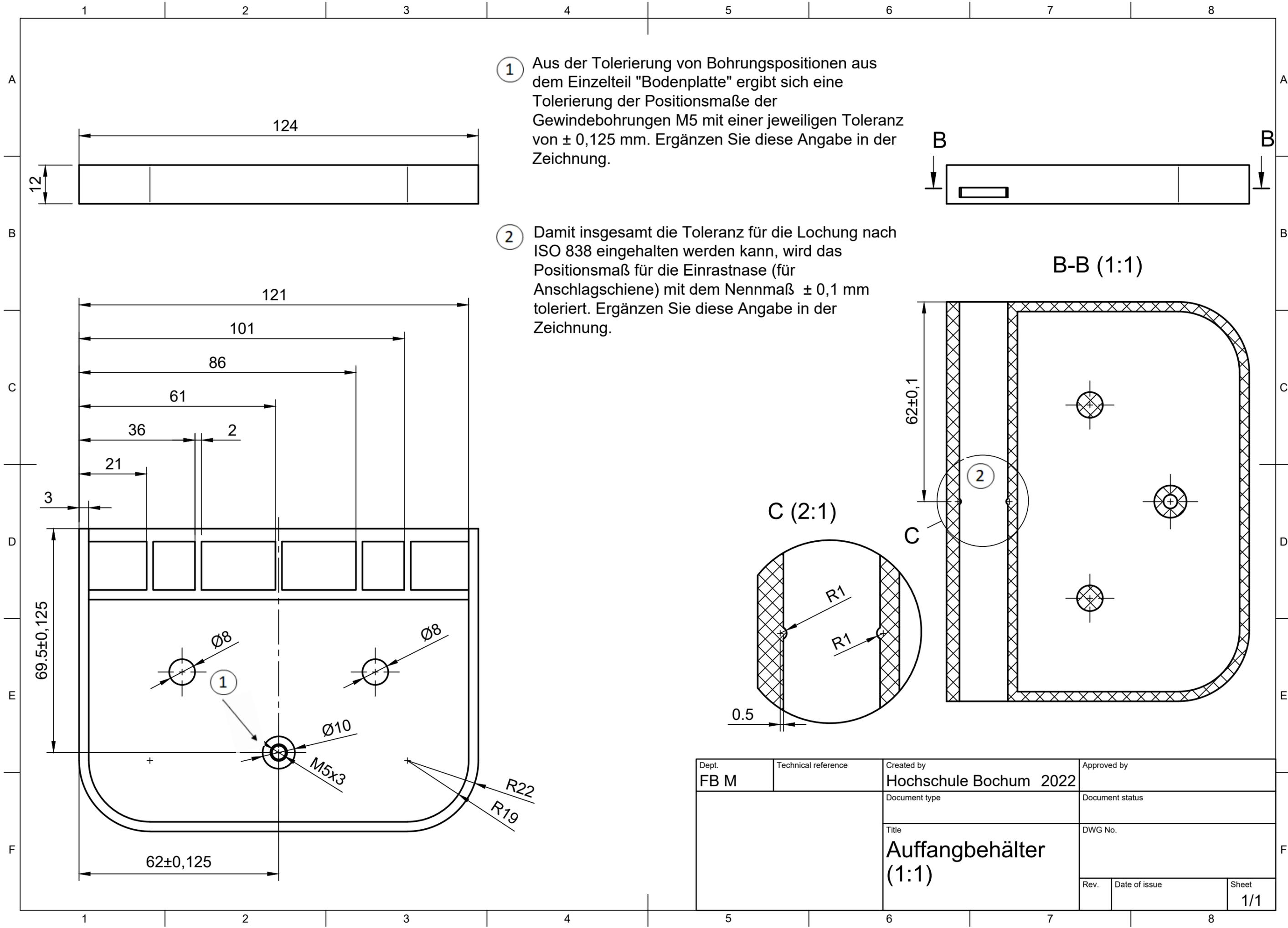
① Aus der Tolerierung von Bohrungspositionen aus dem Einzelteil "Bodenplatte" ergibt sich eine Tolerierung der Positionsmaße der Gewindebohrungen M5 mit einer jeweiligen Toleranz von  $\pm 0,125$  mm. Ergänzen Sie diese Angabe in der Zeichnung.
