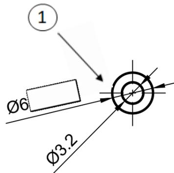
1 Das Passungssystem Stempel / Durchgangsbohrung Seitenteil / Durchgangsbohrung Bodenplatte soll nach dem System Einheitsbohrung (mit Spiel) toleriert werden. Ergänzen Sie die Toleranzangabe des Außendurchmessers des Stempels!
