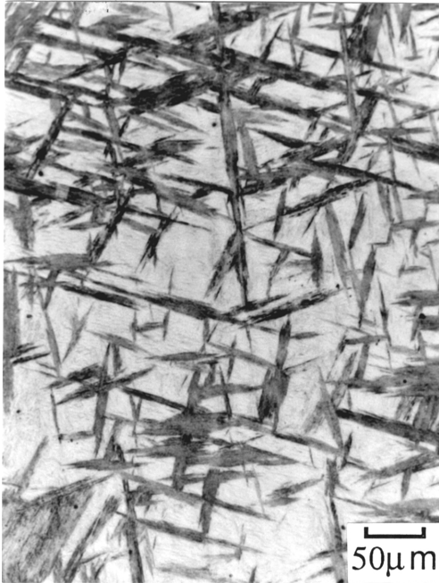
Lichtmikroskop dunkel: Bainit „sheaves“; hell: Martensit
