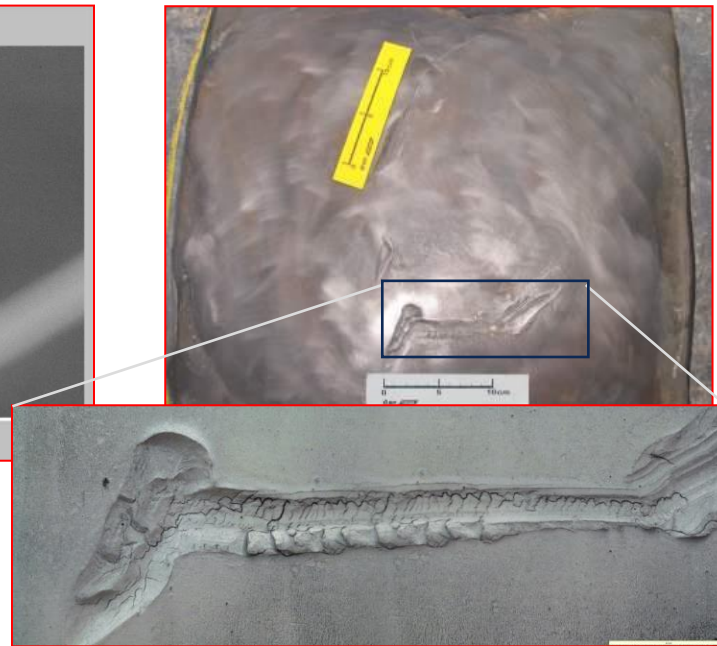
Gouges due to TPI
