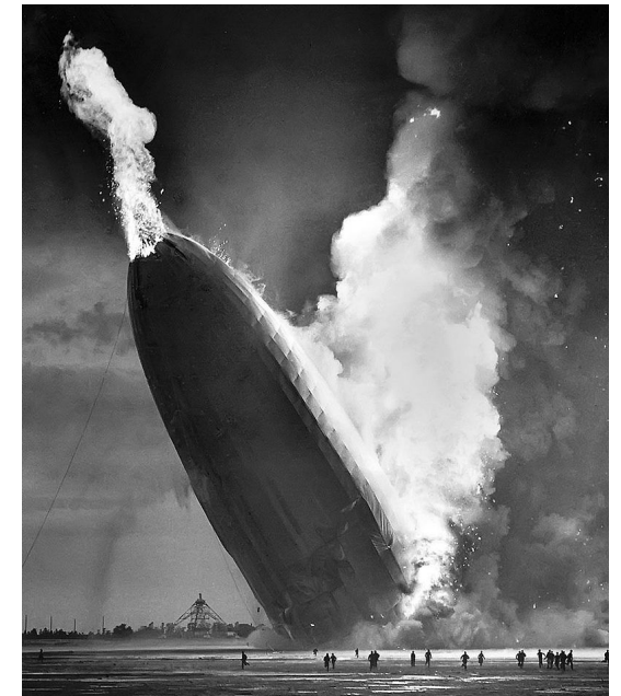
Das Feuer schießt, über den Axialsteg kommend, aus dem Bug des Luftschiffs, Murray Becker, Public Domain†
