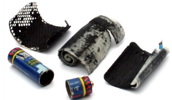
Aufbau einer Nickel-Batterie, (hier am Beispiel einer NiCd) Download for free at https://openstax.org/details/books/chemistry-2e .
