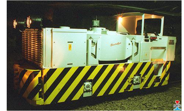
Gyro-Lokomotive untertage; Felix Hasler; https://rail.lu/materiel/mfogyrolok.html
