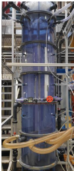
Abbildung 1- Darstellung einer flexiblen Rektifikationskolonne
