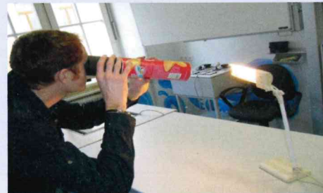
Abb. 2: So beobachtest du einen Gegenstand mit der Lochkamera. Den Auszug kannst du herausziehen, damit vergrößerst du den Abstand zwischen Lichteinlass und Schirm.
