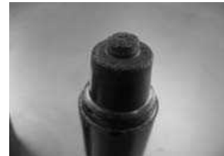
Verschleiß an Stempel nach 8 Schmiedungen
