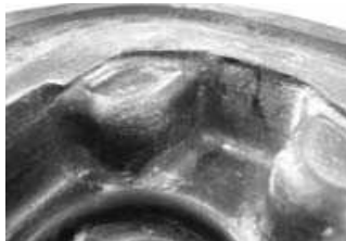
Korrosion im Gesenk
