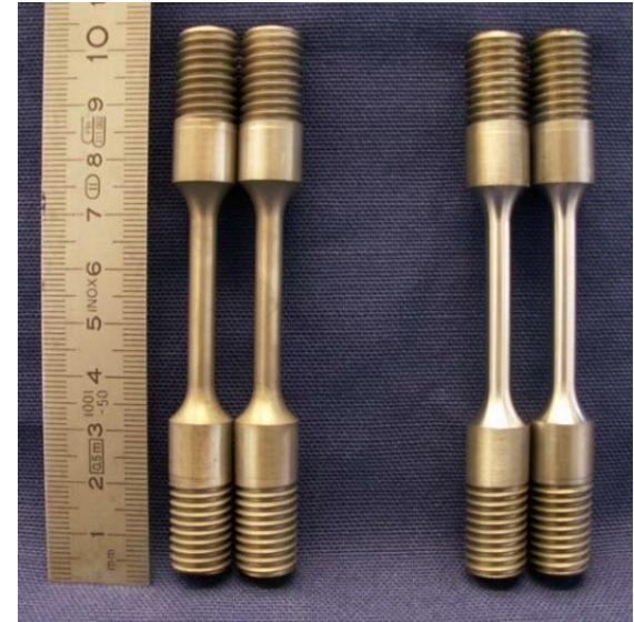
Rundzugproben aus 1.4307 zur Prüfung in Druckwasserstoff
