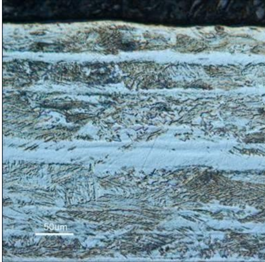
Längsschliff 1.4307 nach Zugprüfung => Was fällt auf ?
