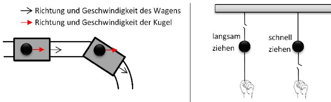
Abbildung 7.1.: Links: Ändert der Wagen seine Bewegungsrichtung, so behält die Kugel im Raum ihre Geschwindigkeit und Richtung bei. Rechts: Beim langsamen Ziehen, reißt der obere Faden, da Zugkraft und Gewichtskraft auf die Kugel wirken. Beim schnellen Ziehen reißt der untere Faden, da die Kugel der abrupten Bewegungsänderung nicht sofort folgen kann.
