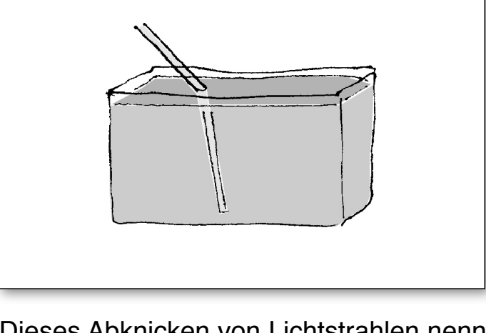
Abb. 21.37 Das Lichtbündel wird an der Wasseroberfläche geknickt.
