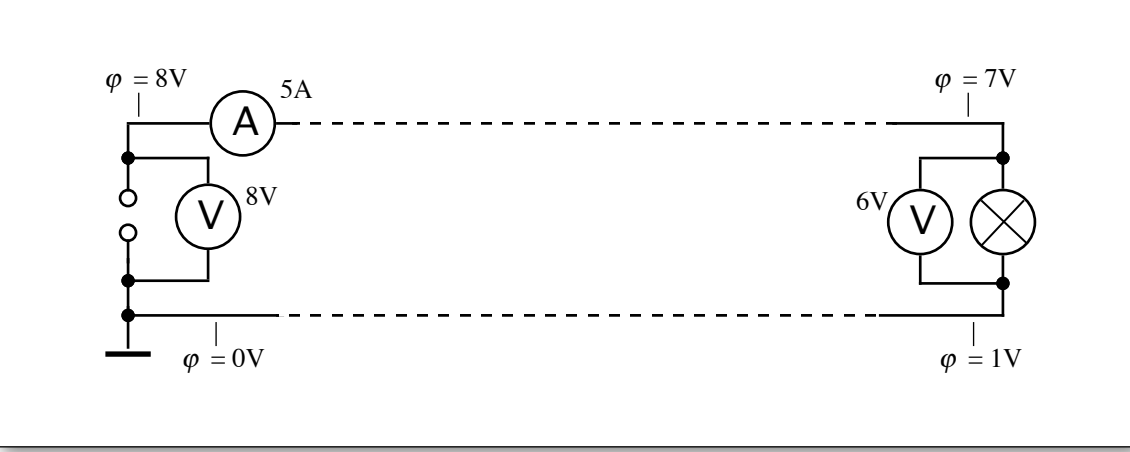
Abb. 17.6 Die Spannung an der Lampe ist niedriger als am Netzgerät. Zwei Volt werden gebraucht, um die Elektrizität durch die langen Leitungen zu drücken.
