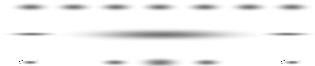
Abb. B.1: Oben: Muster eines Doppelspalts mit sehr engen Spalten, Mitte: Muster eines Einzelspalts E Unten: Muster eines Doppelspalts bestehend aus zwei Einzelspalten E
