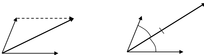
Abb. 1.3: Nur wenn die Kräfte nach den Gesetzen der Vektoraddition ersetzt werden, gelingt die Beschreibung der Natur.
