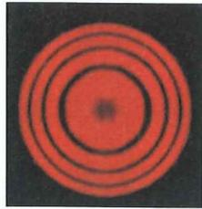
B1 Interferenzmuster beim Interferometer
