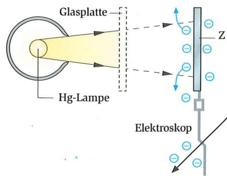
**V1** UV-Licht einer Quecksilberdampf-Lampe entlädt die frisch geschmirgelte, negativ geladene Zinkplatte Zn, erkennbar am Elektroskop. Bringt man die Glasplatte in den Strahlengang, so absorbiert sie UV-Licht und verhindert die Entladung.
